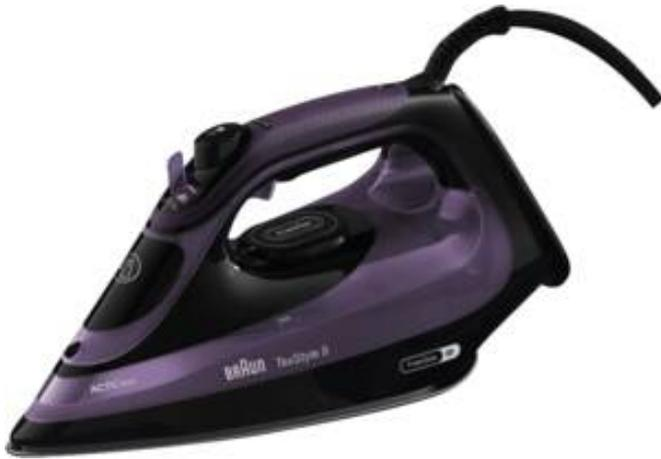
Dampfbügeleisen, iCare Technologie (automatische Temperatureinstellung), FreeGlide 3D-Bügelsohle, 3.100 Watt, Dampfleistung: bis 60 g/Min., regelbar, Extra-Dampfstoß: 250 g/Min., Vertikaldampf, 330 ml Wassertank, Tropf-Stopp, Abschaltautomatik, Kabellänge: 2,5 m, Anti-Kalk-Selbstreinigungsfunktion, leitungswassergeeignet
